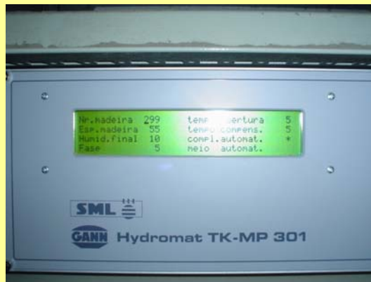
► Comando do secador. Pode ser adquirido um PC onde é instalado o Software GANN TKMP 4032, que monitoriza e grava todos os dados do Comando.
