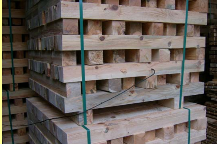
► Colocação da sonda de temperatura na madeira mais grossa. Martos & C.ª, Lda. Colmeias, Leiria.
